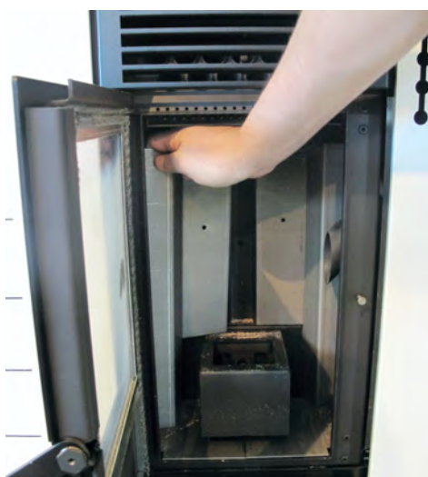
4. Izvadite unutarnje limove ložiš
